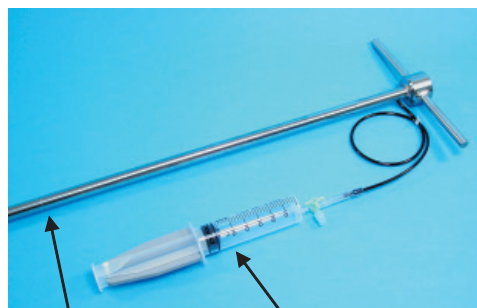
土壌ガスサンプラー シリンジ(三方コック、ストッパー付) Soil Gas Sampler Syringe (with a 3 direction cock, a stopper)
