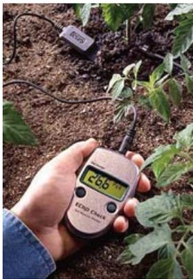
エコチェックは、ECH<sub>2</sub>O プローブと直接接続し、簡単に、そして瞬時に土壌水分を測定します。
