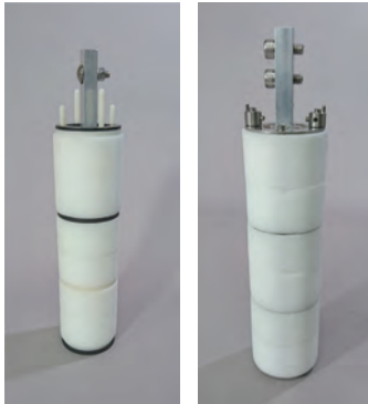
流向流速計センサー部 (左:プラスチック, 右:ステンレス) ステンレス筐体を製品化 VP50, VP65 用の2タイプで 現地試験実績あり
