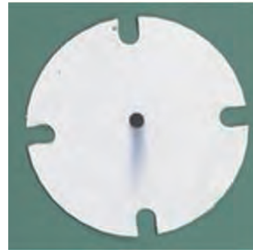
測定手順 2 一定時間静止し引き上げる。ペーパーに発生した尾引き（テーリング）の長さや方位を専用定規で読み取り流向流速に変換
