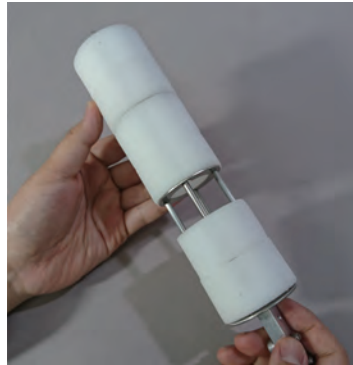
測定手順 1 ペーパー・スポンジをセットし、方位を確かめ井戸のストレーナ区間に設置 *注) ストレーナの開口率は20%程度必要
