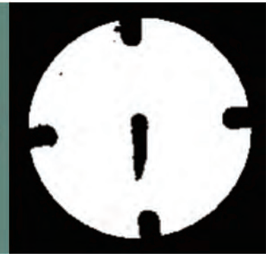
測定手順 3 スキャナー（別売）で電子化し画像解析ソフト（別売）でテーリングを解析すればより高精度な解析が可能
