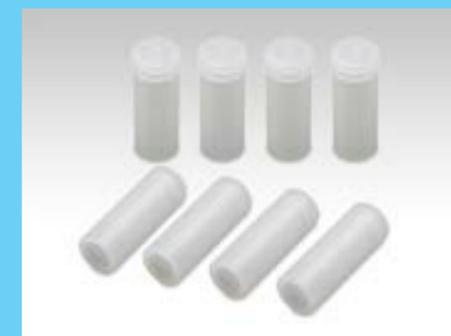
粉碎棒は、粉碎効率を上げるため、比重の重いモリブデン製の金属芯を使用。ポリプロピレンのケースを被せて石を粉碎しないように工夫されています。
