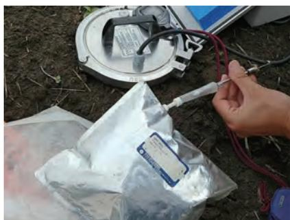
④ガス採取袋からガスを採取します
