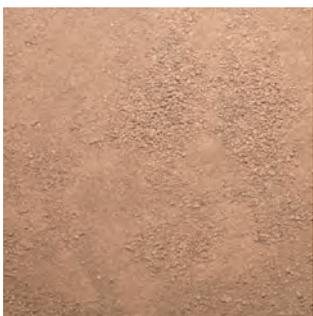
90秒間粉碎篩分け後、2mmの円孔篩を通過した土壌(粒径約2mm以下)の状態
