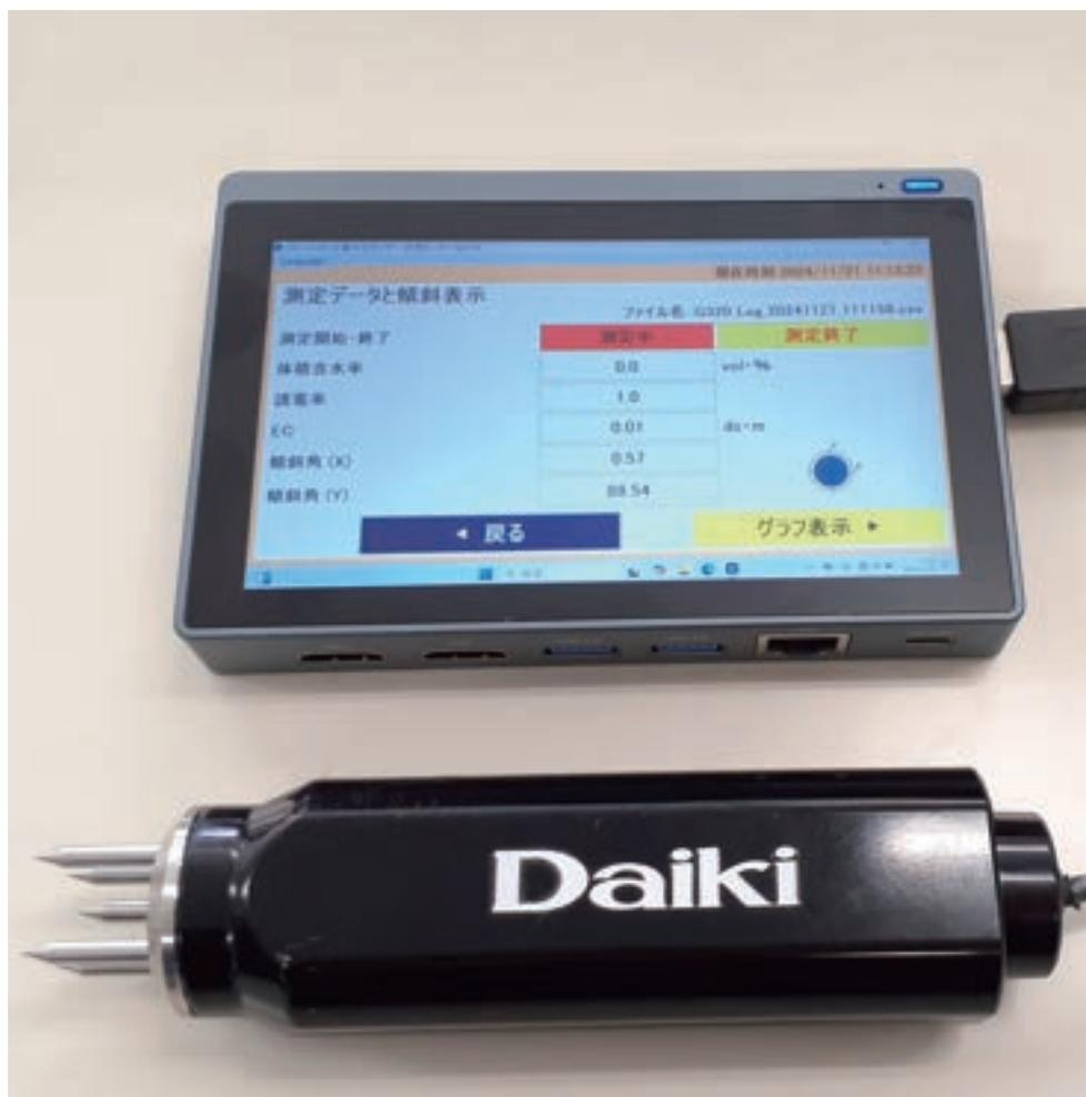
比誘電率・体積含水率・電気伝導率・傾斜角の4項目を同時に測定可能です
