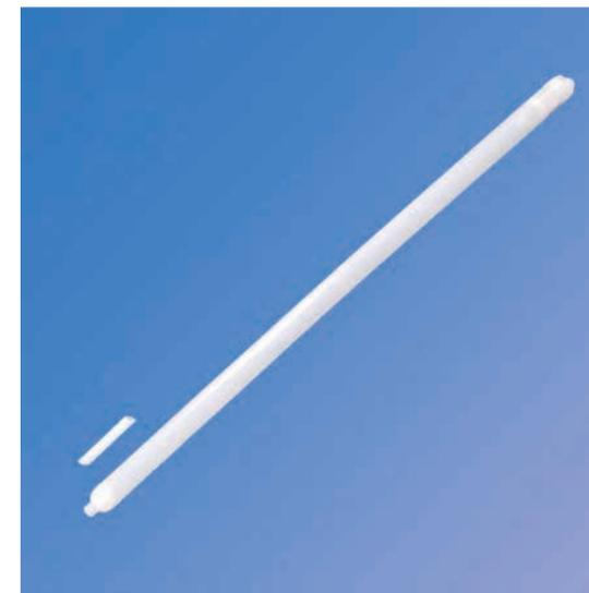
使い捨てとしても使用できるこちらのベイラーは、現場でのメンテナンスとコンタミネーションを軽減させることができます。特長として、上部構造とステンレスの重りにより、他のベイラーと比べて同等以上の速度で注水および空にすることができます。さらに、アメリカで特許取得済みの Dome Design™ を上部と下部に採用したことにより、井戸への出入りが容易になります。
