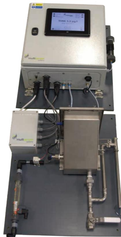
塩素または塩素ベースの消毒剤を使用して水を消毒すると、フミン酸やフルボ酸などの天然有機物 (NOM) と相互作用し、トリハロメタン、ハロ酢酸などのDBPs (消毒副生成物) が生成されます。THM (総トリハロメタン) は、各国の異なる法律に従って世界各地で監視されています。世界各国での測定方法の多くは、測定サンプルを人的に採取しています。この方法ではサンプルの収集、保存、前処理などにおいてミスが発生しやすくなります。測定者は定期的あるいは必要に応じてサンプルを採取しますがその頻度は国や会社によって異なります。また、採取されたサンプルは専門の技術者が、GC-MSまたはGC-ECD (Electron Capture Detector) を使用して分析をします。そのため、リアルタイムに測定結果を得ることができません。
