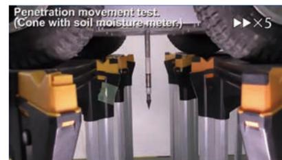
土壤硬度測定用のコーンと土壤水分センサー
