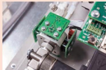
マンチェスター大学との共同研究により開発された Multisensor の“e-Nose”は選択性に優れた半導体センサです。
