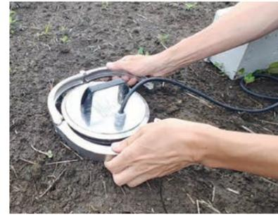
③センサー部を取り付けて蓋をします
